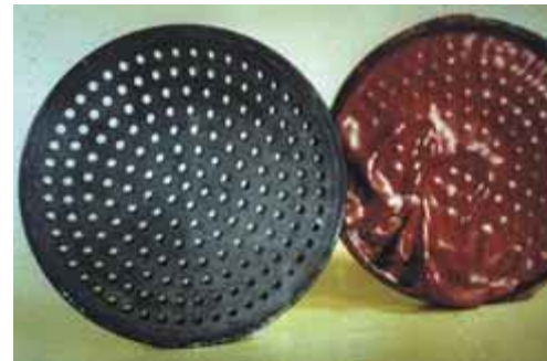
Abb. 43: Mit Polyamid verunreinigte Spinddüsen nach und vor der Salzbadreinigung
