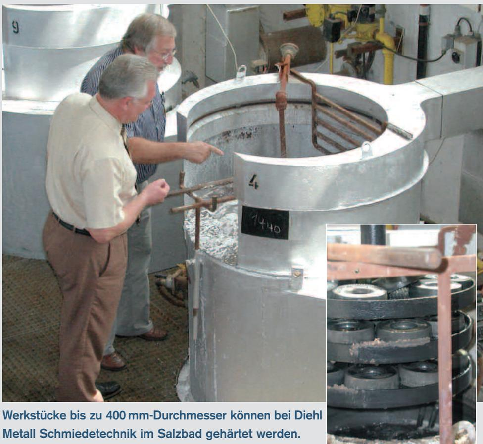
Werkstücke bis zu 400 mm-Durchmesser können bei Diehl Metall Schmiedetechnik im Salzbad gehärtet werden.
